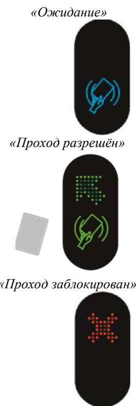
Рис. 7 - Отображения статуса турникета на индикации
